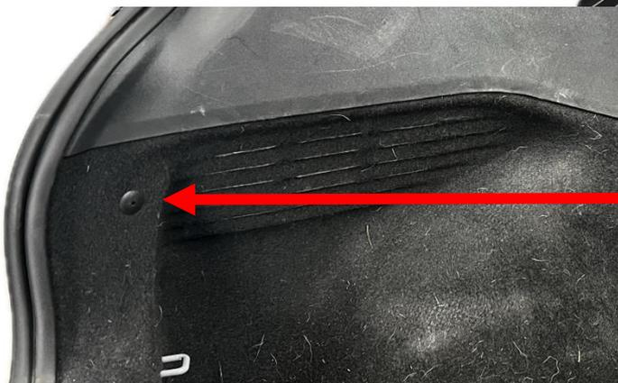
Entfernen Sie diesen Kunststoffdübel und klappen die Verkleidung wie in den Bildern zu sehen um.
