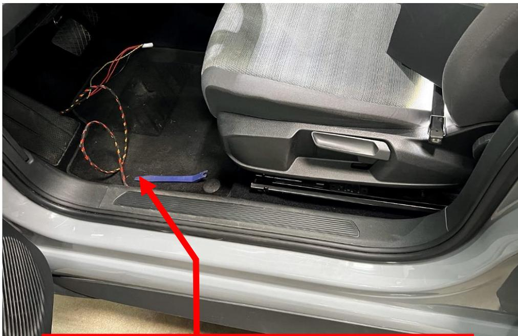
**Führen Sie den Kabelstrang unter der Kunststoffabdeckung bis nach vorne zum Sicherungskasten bzw. der Steuerelektronik des Fahrzeuges.**
